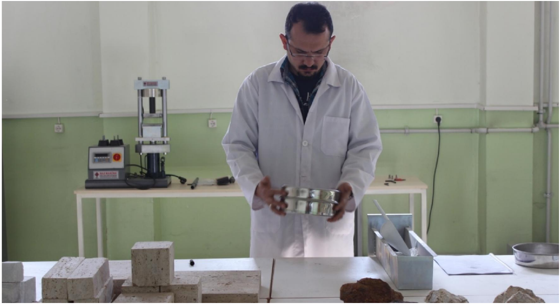
Şekil 8.8. Yoğunluk analizi için numunelerin hazırlanması (kıırma, öğütme ve eleme işlemleri)
