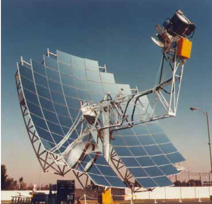
Şekil 2.14. Stirling'li Çanak Sistem [3]
