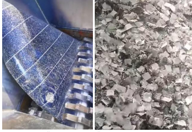
Resim 6: FV Panelin Öğütülmesi ve Öğütme Sonucu Elde Edilen Malzeme ( https://www.youtube.com/shorts/WmMp5w8R_zI )
