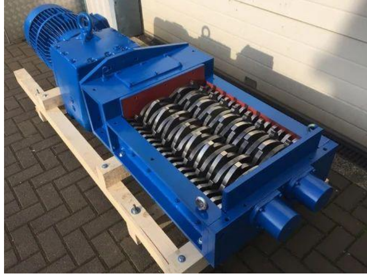
Resim 8: İki Rotorlu Kesme Gerilimli Mekanik Öğütücü
