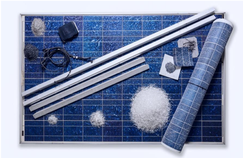
Resim 2: Bir FV Panel ve Geri Dönüştürme Sonrası Elde Edilen Malzemeler (Frelp by Sun, 2022)
