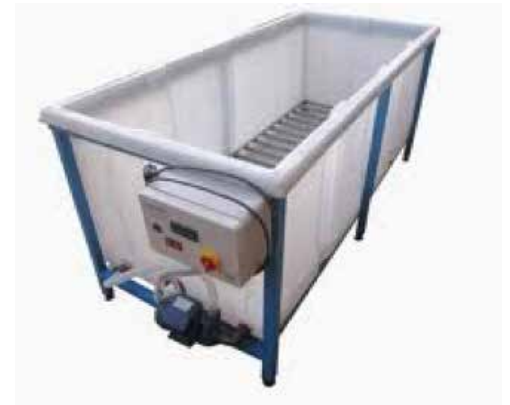
Şekil 4.7: Kür Havuzu (Tank) Cihazının Genel Görünümü
