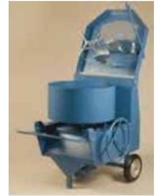
Şekil 4.10: Laboratuvar Tipi Beton Mikserinin Genel Görünümü
