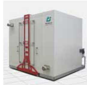
Şekil 4.12: Sıcak Kutu (Hot Box) Yöntemi Deney Düzeneğinin Genel Görünümü
