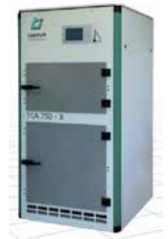
Şekil 4.11: Plaka (Hot Plate) Yöntemi Deney Düzeneğinin Genel Görünümü
