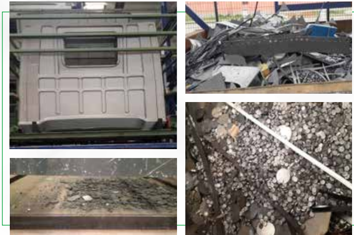
Şekil 5.9 - Kesim İşlemleri Sonrası Oluşan Farklı Ebatlardaki Metal Atıklar
