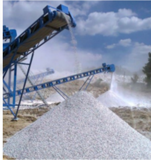
Şekil 5.13 - Mermer Ocaklarından Çıkan Katı Mermer Artıklarının Kum, Çakıl ve Mıdır Haline Dönüştürülmesine Dair Görsel
