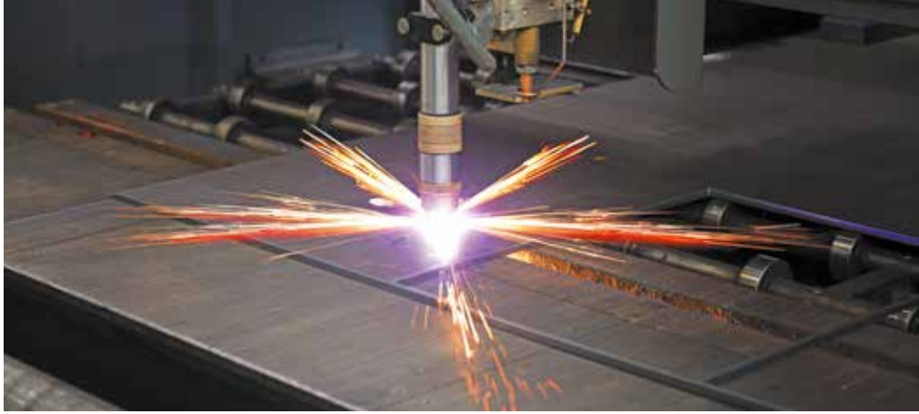
Şekil 5.16 - Metal Şekillendirme Prosesi Esnasında Plazma Kesme İşlemi
