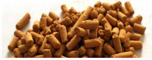
Şekil 5.18 - Endüstriyel Üretim Sonucu Elde Edilen Demir Oksit ( Fe_2O_3 ) 134
