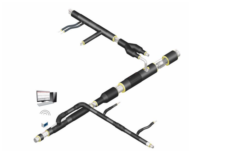
Şekil 27 Ön izolasyonlu Borularla Kaçak İzleme
