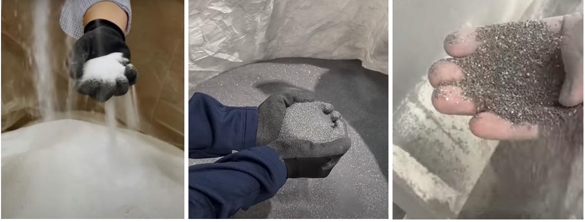
Resim 7: Mekanik Öğütme ve Eleme İşlemlerinden Çıkan Toz Malzeme (cam, silisyum ve plastik)
