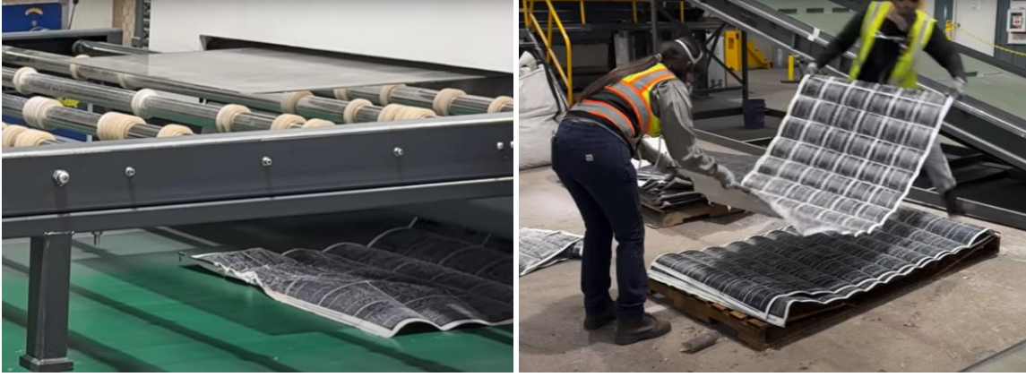
Resim 9: (a) Camın Kesici Bıçak ile Panelden Ayrılması ve (b) Sonrasında Panelin Kalan Kısmı ( https://www.youtube.com/watch?v=FCtEWveySsA )
