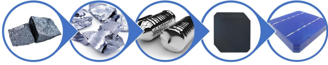
Resim 1: k-Si FV Hücre Üretim Süreci
