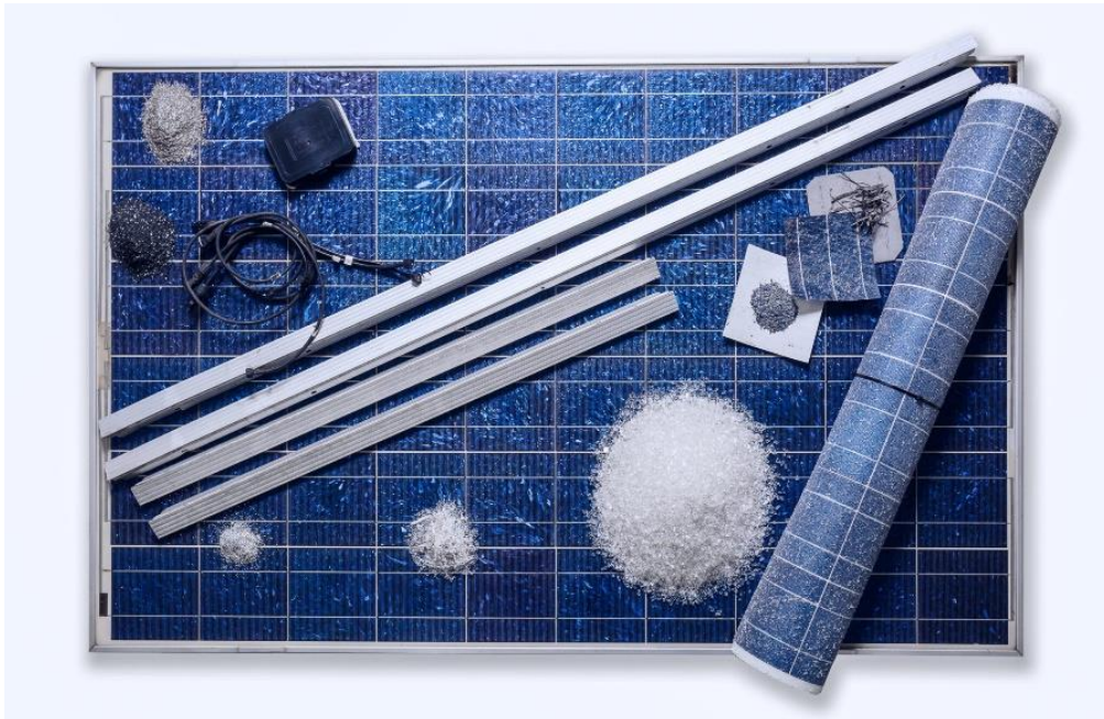
Resim 2: Bir FV Panel ve Geri Dönüştürme Sonrası Elde Edilen Malzemeler (Freip by Sun, 2022)
