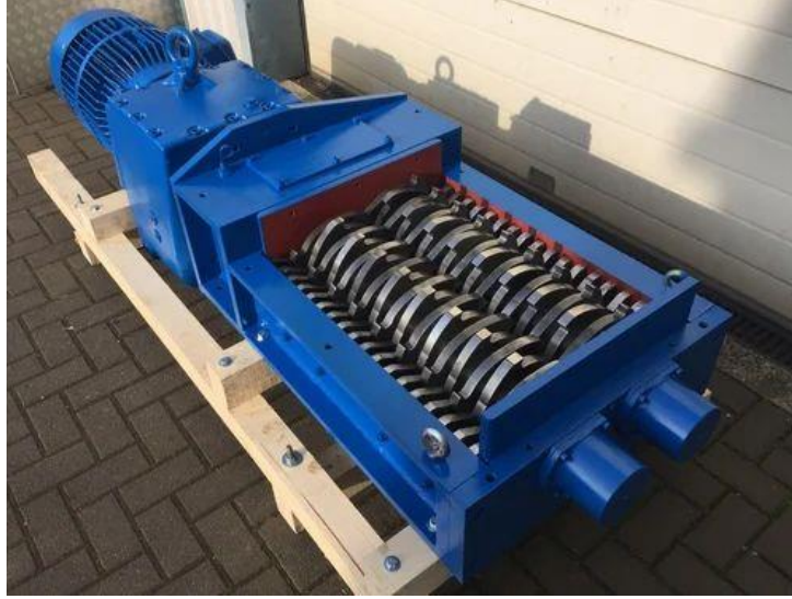
Resim 8: İki Rotorlu Kesme Gerilimli Mekanik Öğütücü
